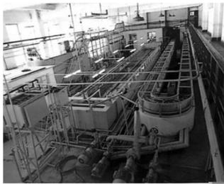
图1 温差异重流试验水槽
