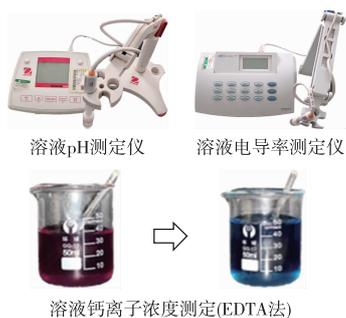
图 1 溶液指标测定试验
