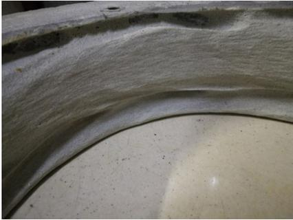
图5 高强环氧砂浆圆环法试验后冲磨情况
