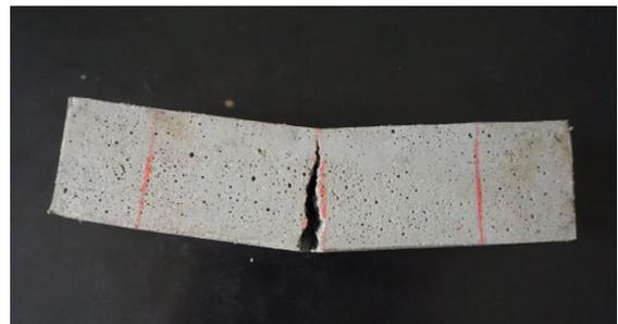
图 2 特种抗冲磨砂浆抗折试验破坏形态
