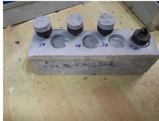
图 4 55℃高温水浴后黏接试验
