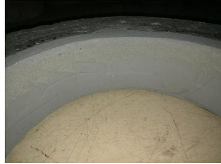
图6 SK-PAM 特种抗冲磨树脂砂浆抗冲磨试验后冲磨情况
