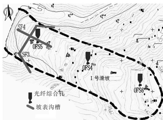
图6 光纤传感器布设位置示意
